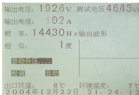
图 28 PY3520 变频电源装置自动升压过程显示
