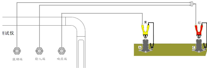
图 2 频响法测试接线图
