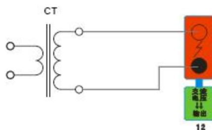
2. 接线图：图二 （CT 变比接线图）
