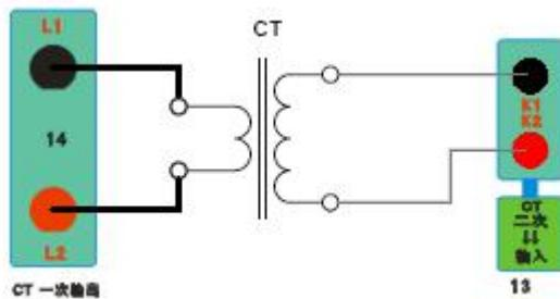
3. 接线图：图三 （二次回路接线图）
