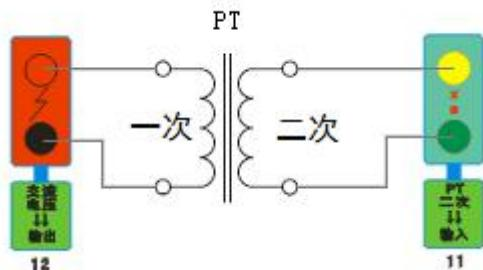
6. 接线图：图六 （二次耐压接线图）
