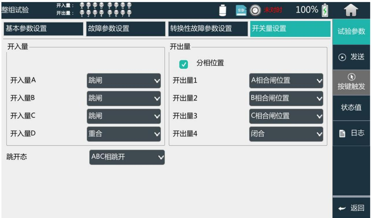
图 5.12-4 整组实验开关量设置
