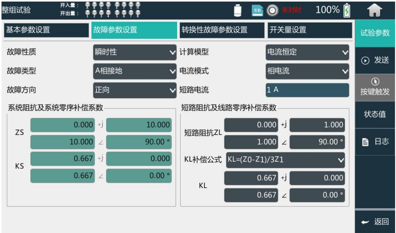
图 5.12-2 整组实验故障界面
