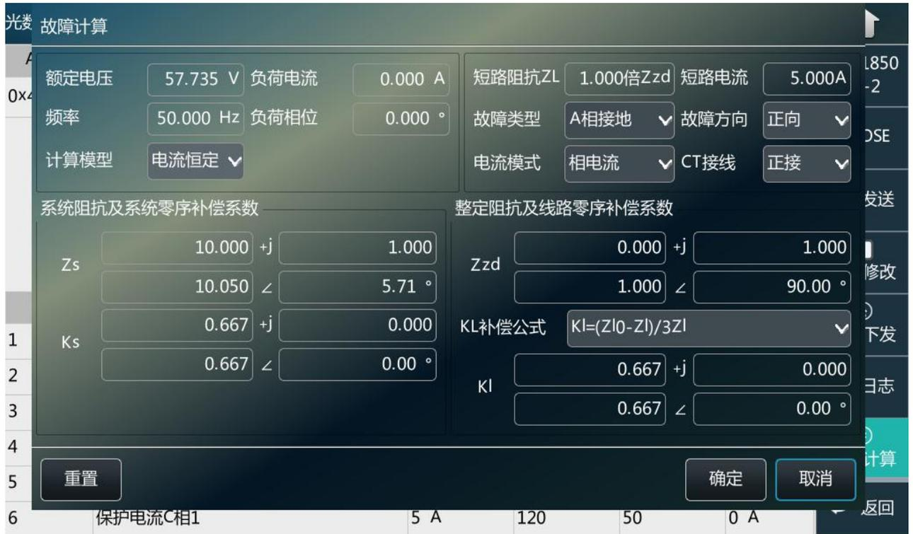
图 5.7-4 故障计算设置界面
