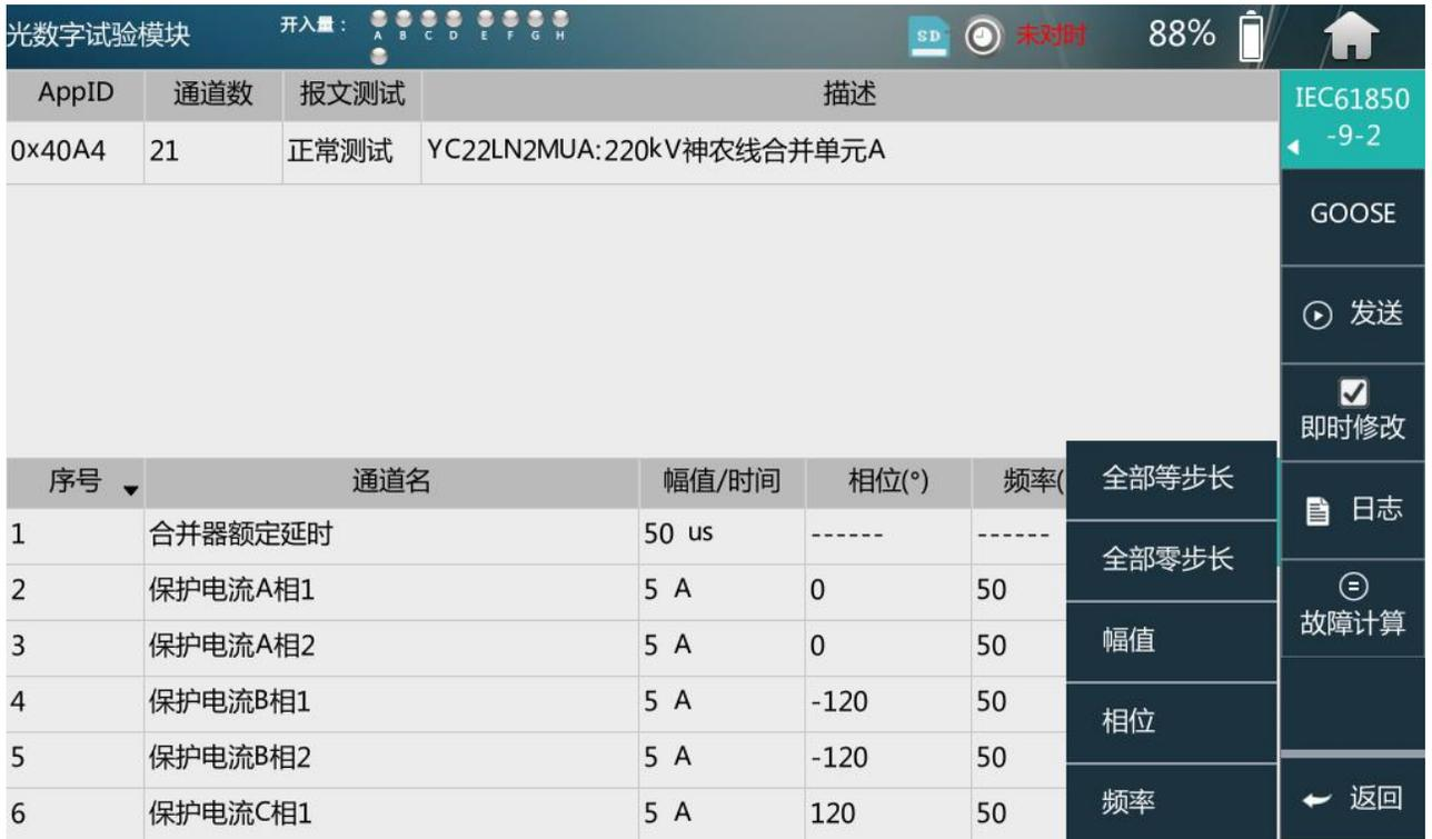
图 5.7-3 变化步长类型设置界面
